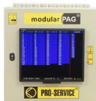
Fot. 3. Wielodetektorowa skalowalna centrala modularPAG
