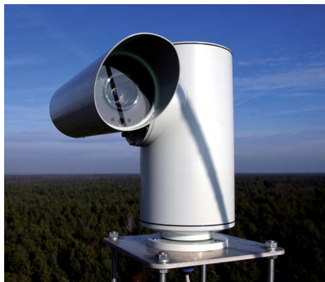
Fot. 1. Najnowszej generacji system telewizyjny przeznaczony do obserwacji obszarów leśnych
