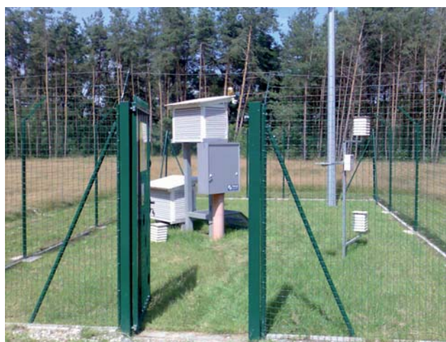
Fot. 2. Automatyczny punkt pomiarowy do określania stopnia zagrożenia pożarowego lasu
