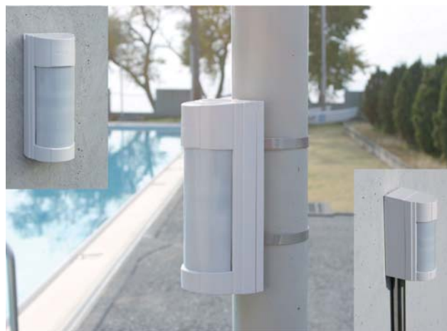
Fot. 2. VXi można montować bezpośrednio na ścianie lub z wykorzystaniem natynkowej rurki na przewody. Do montażu na słupie należy zastosować regulowane opaski metalowe
