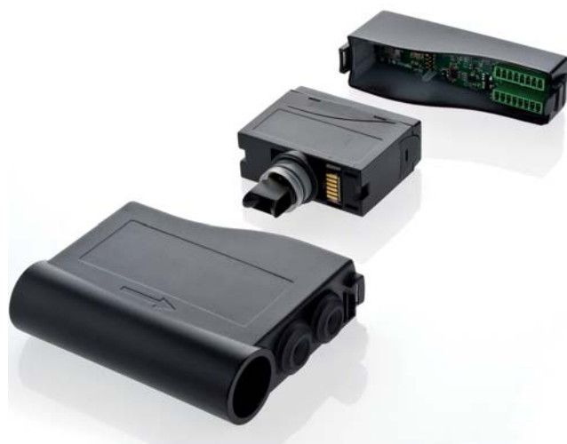
Fot. 2. Czujka gazu ECO. Od lewej: obudowa z widocznym gniazdem rury zasysającej i strzałką wskazującą kierunek montażu; wymienny kartridż na dwa sensory gazu; pokrywa zawierająca układy elektroniczne i łączówki
