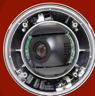
Fot. 2. Kamera obrotowa JVC TK-C686E
