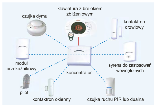
Rys. 2. Zestawienie urządzeń w technologii wLSN
