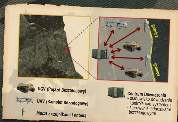
Rys. 1. Koncepcja działania systemu TALOS
