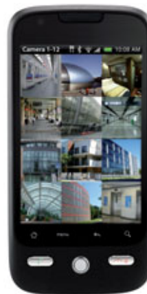
Fot. 2. Mobilna wersja oprogramowania NetStation umożliwia podgląd obrazów z kamer APER IP na dowolnym telefonie komórkowym
